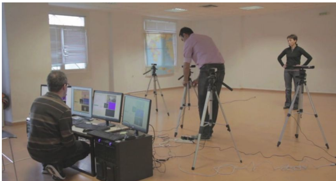
Εικόνα 2. Ανάλυση κίνησης με τη βοήθεια πολλαπλών αισθητήρων Kinect
